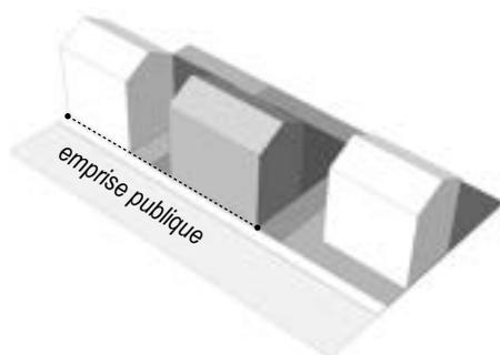
Principe d'implantation à l'alignement des voies admis pour les habitations ou fondé sur une construction existante.
