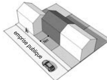
Principe d'implantation avec un recul différent ou moyenneté fondés sur une construction existante
