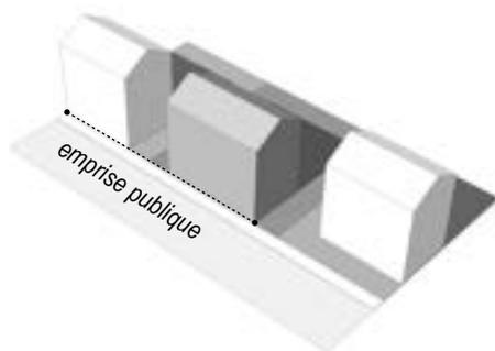
Principe d'implantation à l'alignement des voies admis pour les habitations ou fondé sur une construction existante (où lorsque les OAP le prévoient).
