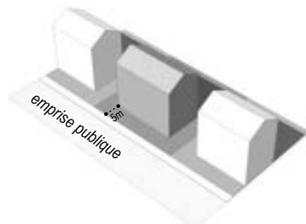
Principe d'implantation observant un recul de 5 m (pouvant être réduit à 3 m pour les habitations)
