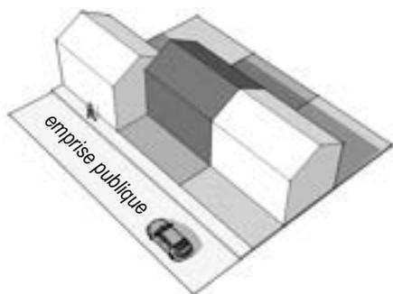
Principe d'implantation avec un recul différent fondé sur une construction existante.
