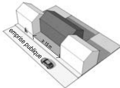
Principe d'implantation avec un recul différent lorsque la façade sur rue est au moins égale à 15 m.
