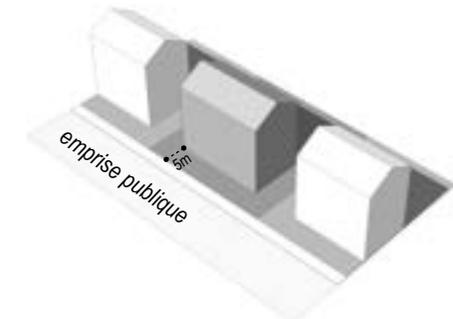
Principe d'implantation observant un recul de 5 m
