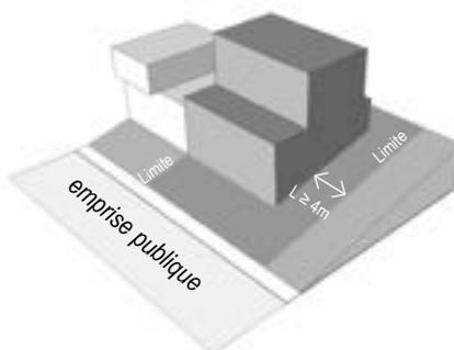
Principe d'implantation en limite séparative ou observant un recul minimal de 4 m
