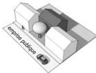
Principe d'implantation avec un recul différent fondé sur de la végétation existante.
