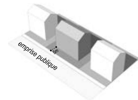
Principe d'implantation observant un recul de 5 m (pouvant être réduit à 3 m pour les habitations)
