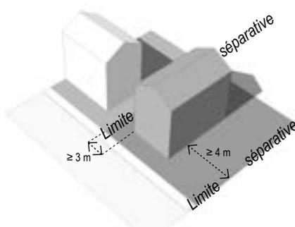
Principe d'implantation observant un recul minimal de 4 m
