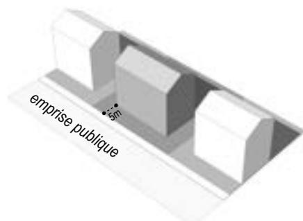
Principe d'implantation observant un recul de 5 m
