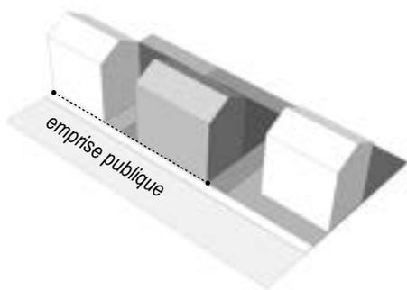
Principe d'implantation avec un recul différent fondé sur une construction existante.
