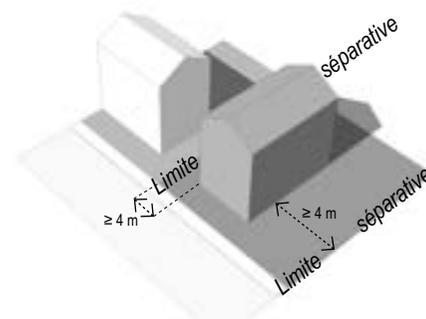
Principe d'implantation observant un recul minimal de 4 m
